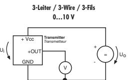
**Versorgungsstromkreis / Supply Circuit / Circuit d'alimentation****Signal- und Schnittstellenkreise zusammen / Signal- and Interface Circuits combined / Circuit de sortie**
